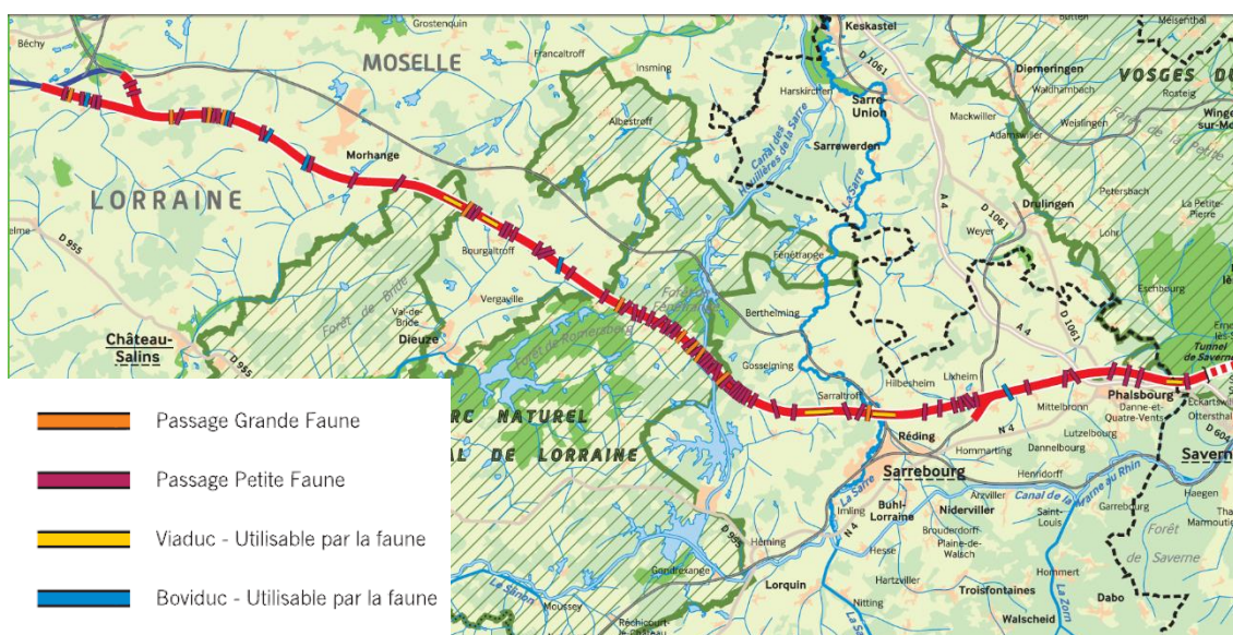
Carte 49 : Passages faune prévus sur le tronçon lorrain de la LGV est en cours de construction (source RFF)
